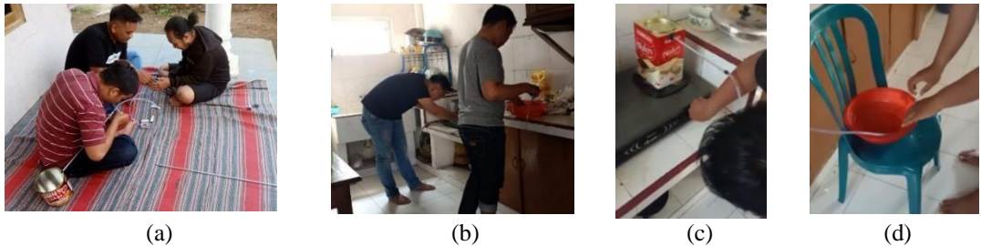
Gambar 2. a) Proses pembuatan tungku pembakaran, b) Proses memasukkan sampah ke tabung pembakaran, c) Proses pembakaran, d) Proses penyulingan
