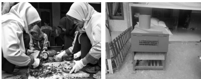
Gambar 5 perajangan manual dan perajangan mesin
